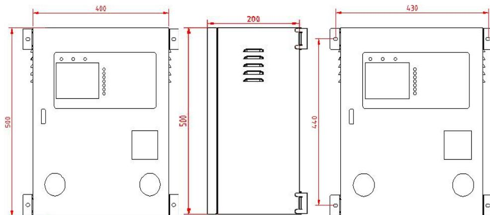
图 1 外形尺寸及安装尺寸图
