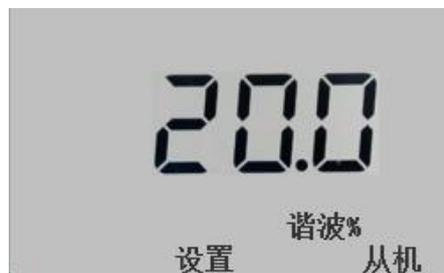
当检测到电压总谐波含量大于设置值时，显示“谐波”提示。
