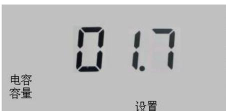
注：当智能电力电容补偿装置的补偿方式为分相时，设置值为单相的容量。如：分补总容量为5Kvar，则设置容量应为  $5/3=1.7\text{Kvar}$ 。
