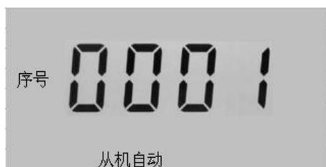
若电容器未组网成功，则序号无显示；若组网成功，如果本机为网络中的控制机则显示为“主机”；如果本机为网络中的受控机则显示为“从机”，并显示本机在网络中的逻辑排序编号；其中主机编号为“0000”。
