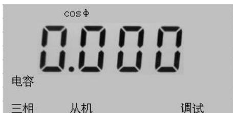
按“设置”键两次光标闪烁,按“▲”或“▼”键选择“调试”模式,按“确认”键,进入调试状态。进入调试状态后，按“▲”键选择电容 1、电容 2 投切控制。
