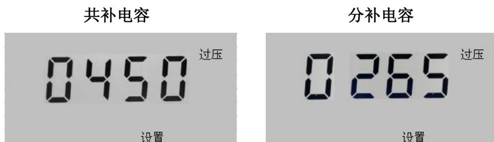
当检测到电压大于过压设置值时,显示“过压”提示。
