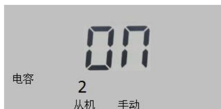
如显示为“OFF”，此电容为切除状态，显示为“ON”，此电容为投入状态，按“确认”键可以进行投、切转换。
