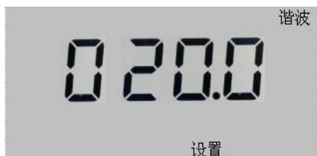
当检测到电压总谐波含量大于设置值时，显示“谐波”提示。
