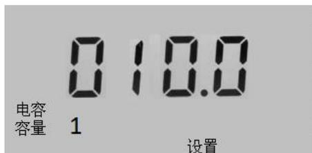
注：当智能电力电容补偿装置的补偿方式为三相时，设置值为电容器单台容量值。如：三相容量为 10+5Kvar,则设置电容 1 的容量为 10Kvar。
