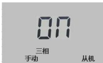
如显示为“OFF”，此电容为切除状态；显示为“ON”，此电容为投入状态；按“确认”键可以进行投、切转换。
