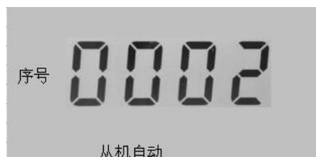
若电容器未组网成功，则序号无显示。若组网成功，如果本机为网络中的控制机则显示为“主机”。如果本机为网络中的受控机则显示为“从机”，并显示本机在网络中的逻辑排序编号；其中主机编号为“0000”。
