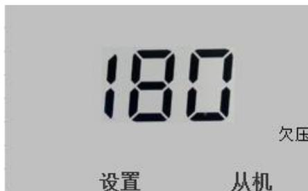
当检测到电压小于欠压设置值时，显示“欠压”提示。
