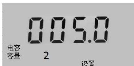
注：当智能电力电容补偿装置的补偿方式为三相时，设置值为电容器单台容量值。如：三相容量为 10+5Kvar,则设置电容 2 的容量为 5Kvar。
