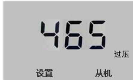
当检测到电压大于过压设置值时，显示“过压”提示。
