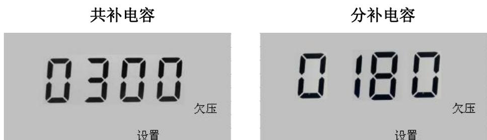
当检测到电压小于欠压设置值时,显示“欠压”提示。
