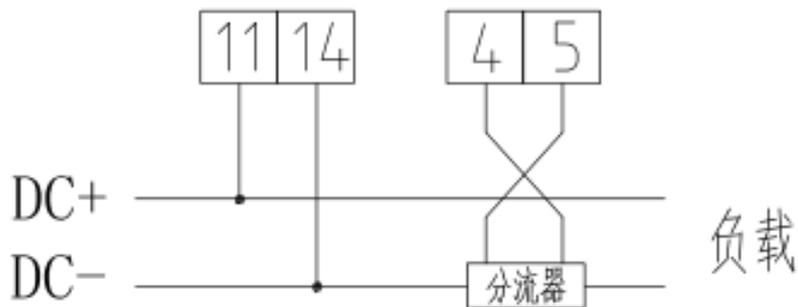
图 4 外置分流器接线示意图
