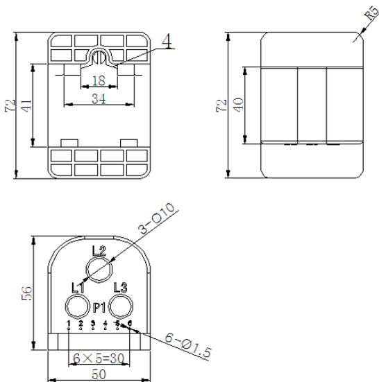
注：互感器引出线为6根（标注有1、2、3、4、5、6） $\phi$ 1.5mmRV软导线，红色为S1，黄色为S2，且引出线必须固定在P1面，且S1、S2引出线长3m $\pm$ 10cm；一次电流从P1面进，P2面出。
