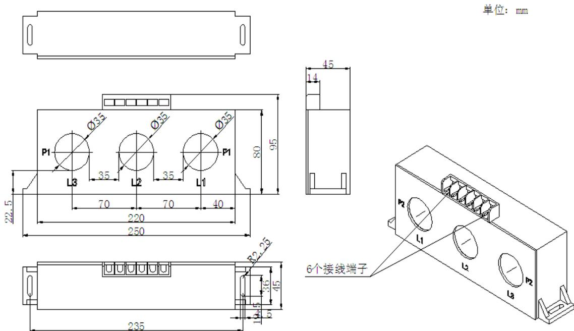
注: 本产品有 6 个接线端子, 其中 1S1、1S2 为 L1 的接线端子, 其中 2S1、2S2 为 L2 的接线端子, 其中 3S1、3S2 为 L3 的接线端子。
